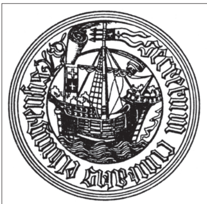
Abb. 8: Das Elbiger Sekret von 1433 zeigt einen Holk mit der für zusammengesetzte Masten typischen Taumwicklung. Nach Ewe, Nr. 43.
