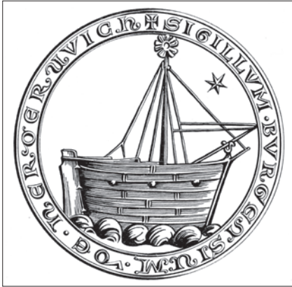
Abb. 11: Bei der Kogge auf dem Siegel von Harderwijk (ab 1263) sitzt vor den die Steven überlappenden Planken eine dünne Leiste. Nach Ewe, Schiffe (wie Anm. 203), Nr. 62.
