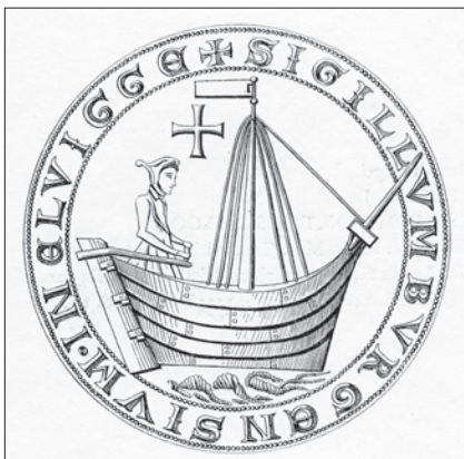
Abb. 9: Bei der Kogge auf dem ersten Elbinger Siegel (ab 1242) überlappen die Planken vorn und achtern die Steven, die dadurch nicht zu sehen sind. Nach Ewe, Schiffe (wie Anm. 203), Nr. 41.
