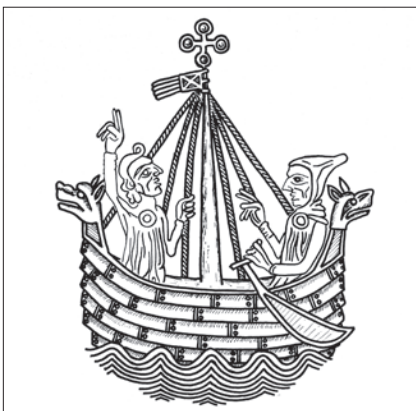
Abb. 21: Auf dem zweiten Siegel von Lübeck (ab 1256) überlappen die Planken vorn und achtern die Steven; das ist typisch für frühe Koggen wie Abb. 9. Nach Wiechell, Schiff (wie Anm. 219), S. 16.
