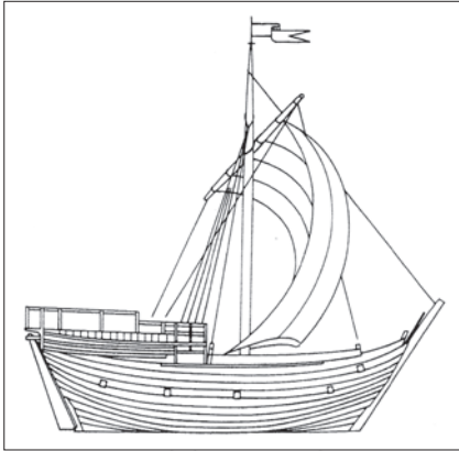
Abb. 16: Seitenansicht des Bremer Schiffsfundes (1380) mit rekonstruierter Takelage. Zeichnung Werner Lahn.
