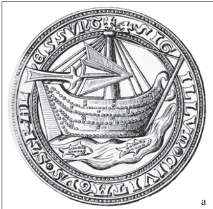
Abb. 12: a. Bei der Kogge auf dem zweiten Siegel von Stralsund (ab 1278) wurde die dünne Leiste durch einen starken Balken ersetzt, der als Außenstevn vor dem überdeckten Innenstevn sitzt. b. Die niedrige Bordwand der genauso gebauten kleinen Kogge für den regionalen Verkehr auf dem Siegel von Künre (um 1400) lässt erkennen, dass die hohe Bordwand auf den anderen Siegeln die großen Koggen anzeigt. Nach Ewe, Schiffe (wie Anm. 203), Nr. 192 und 88.
