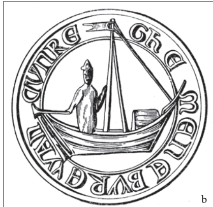
Abb. 12: a. Bei der Kogge auf dem zweiten Siegel von Stralsund (ab 1278) wurde die dünne Leiste durch einen starken Balken ersetzt, der als Außenstevn vor dem überdeckten Innenstevn sitzt. b. Die niedrige Bordwand der genauso gebauten kleinen Kogge für den regionalen Verkehr auf dem Siegel von Künre (um 1400) lässt erkennen, dass die hohe Bordwand auf den anderen Siegeln die großen Koggen anzeigt. Nach Ewe, Schiffe (wie Anm. 203), Nr. 192 und 88.
