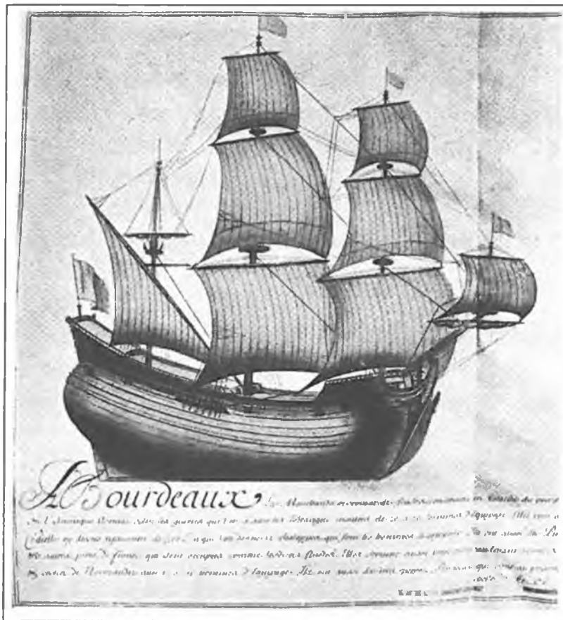
Abb. 3 Fleutschiff (flûte), stark bewaffnetes und daher für die Konvoifahrt ohne Hinzuziehung reiner Kriegsschiffe besonders geeignetes Handelsschiff (Bibliothèque du service Hydrographique, Paris; hier aus Boissonade/Charliat, Colbert et la Compagnie de commerce du Nord (wie Anm. 15, Abbildungsteil, Bl. II).
