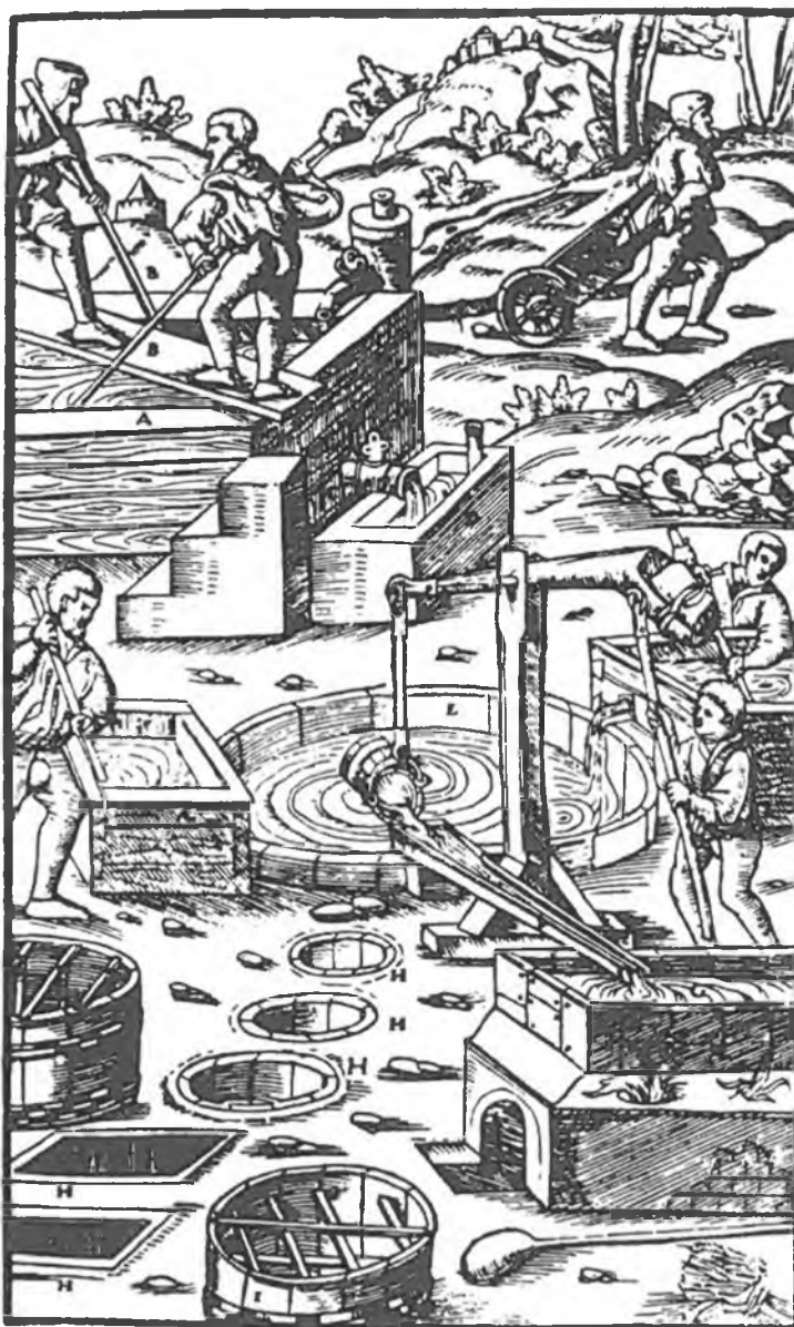
Abb. 2: Alaungewinnung nach Georgius Agricola 1556 (nach Agricola, wie Anm. 26, Kupferstich auf S. 693). G ist eine Bleiwanne zum Eindicken der Alaun-Mutterlauge, H sind in die Erde eingelassene Abkühlbottiche. An den Holzstäben des Kristallisiergefäßes I setzen sich die Alaunkristalle ab.
